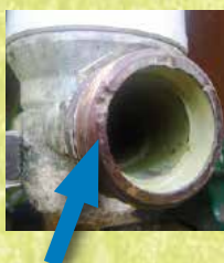
Filetage d'un compteur d'eau endommagé
